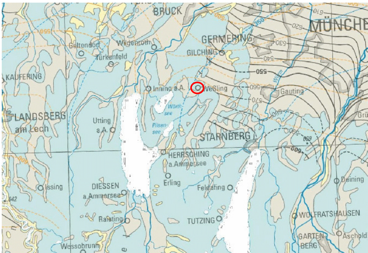
Abbildung 6: Grundwassergleichen bedeutender Grundwasserleiter nach HK500 gem. /U 4/
